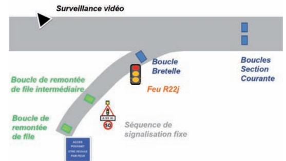
PRINCIPE DE FONCTIONNEMENT DU DISPOSITIF DE RÉGULATION D'ACCÈS | DIRO
